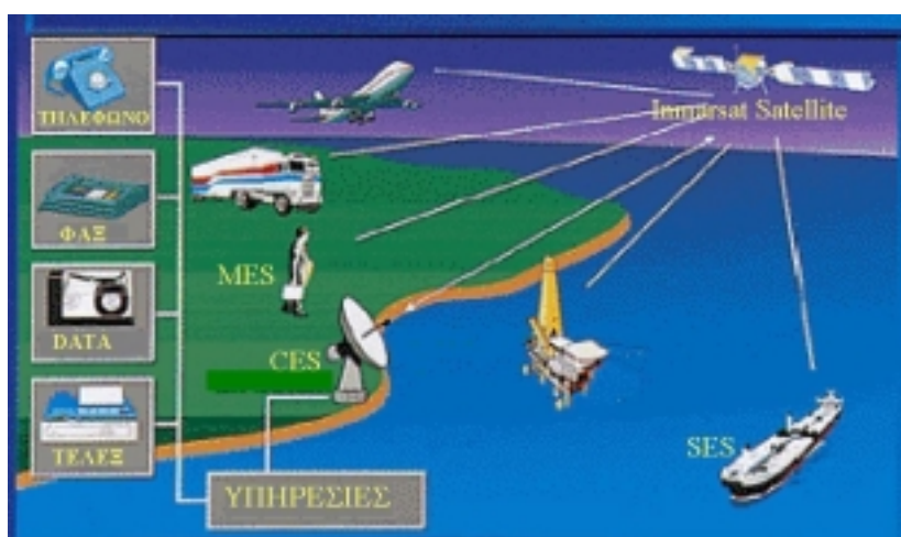
Σχ.18 Σχηματική αναπαράσταση λειτουργίας του Inmarsat
