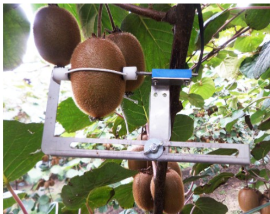
Εικόνα 10. Waspnote Plug & Sense σε φυτεία ακτινιδίου. Εικόνα 11. Αισθητήρας διαμέτρου φρούτων ακτινιδίου.
