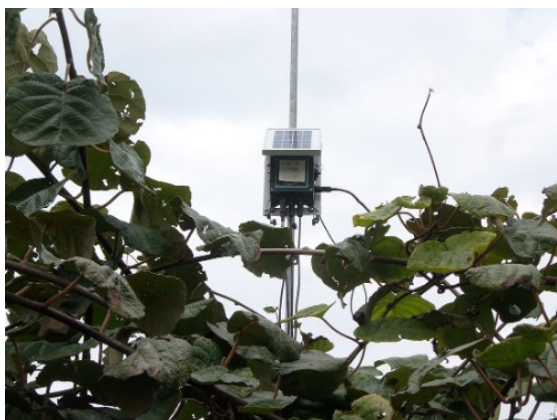
Εικόνα 10. Waspnote Plug & Sense σε φυτεία ακτινιδίου. Εικόνα 11. Αισθητήρας διαμέτρου φρούτων ακτινιδίου.
