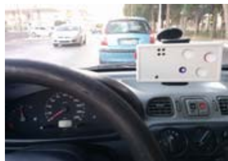
Εικόνα 14 – Τοποθέτηση φορητού συστήματος αισθητήρα στην καμπίνα ενός αυτοκινήτου για την παρακολούθηση της ποιότητας αέρα στο εσωτερικό του
