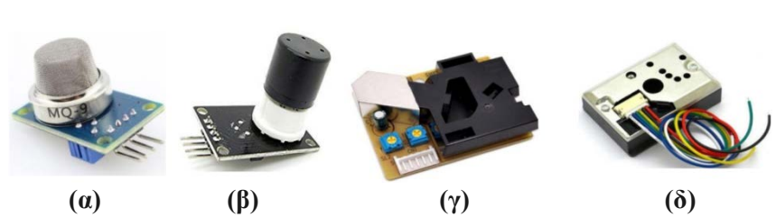
Εικόνα 8 - (α) αισθητήρας CO MQ-9, (β) αισθητήρας MQ-131 O3, (γ) αισθητήρας Shinyei PPD42NS PM2.5 και (δ) αισθητήρας PM2 GP10YA10F PM10
