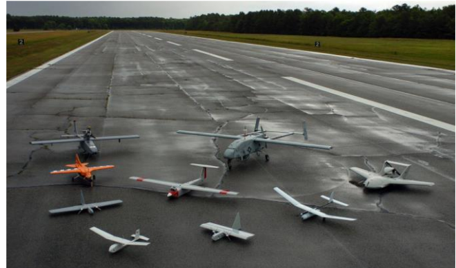
Εικόνα 1. Τα LASE και LALÉ UAV (Πηγή: US Department of Defense)
