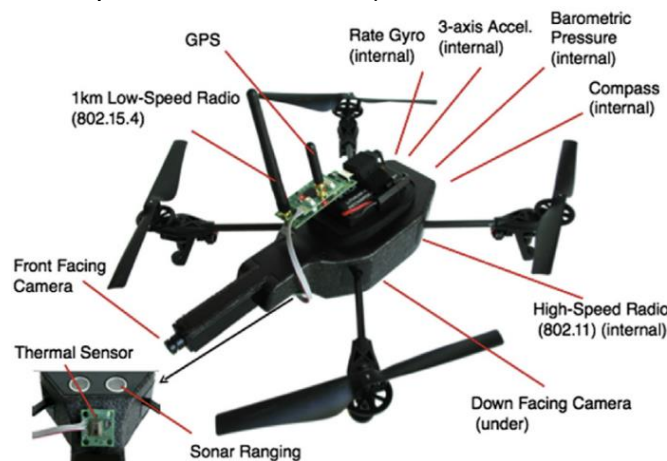
Εικόνα 4. Αισθητήρες drone (Πηγή: Carnegie Mellon University http://wise.ece.cmu.edu/redmine )
