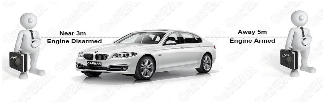
Εικόνα 6. Σύστημα ασφαλείας αυτόματου κλειδώματος με RFID.
