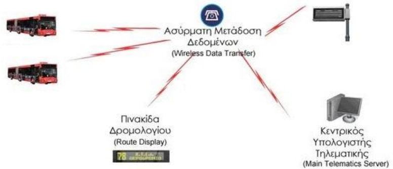
Εικόνα 15. Σύστημα Τηλεματικής ΟΑΣΘ
