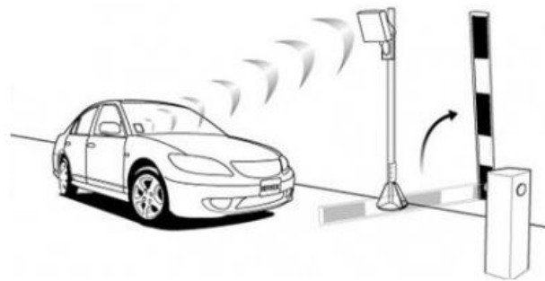
Εικόνα 7. Σάρωση προπληρωμένης κάρτας διοδίων με RFID.
