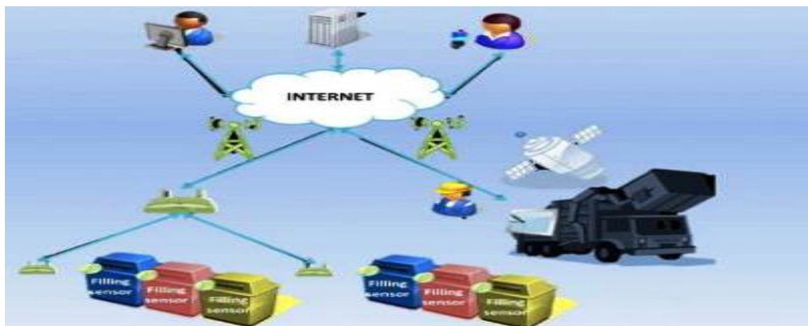
Εικόνα 5: Απεικόνιση αισθητήρων σε σύστημα έξυπνων κάδων
