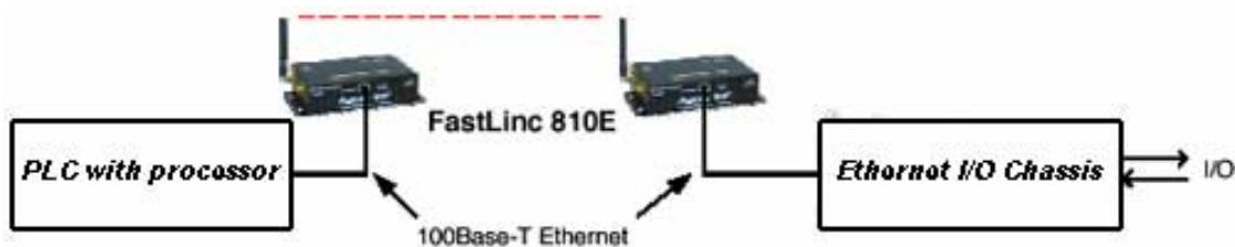
Σχ. 6: Ασύρματο δίκτυο που χρησιμοποιεί το implicit messaging
